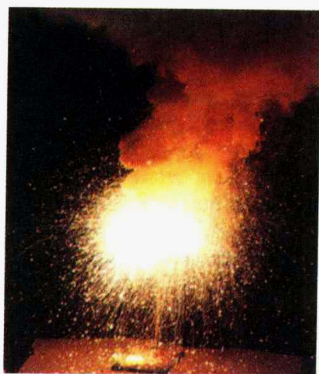
铝粉与氧化铁的反应——铝热反应（放热）
