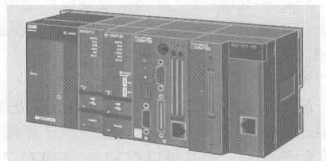
图 1.3.3 模块式 PLC 示意图
