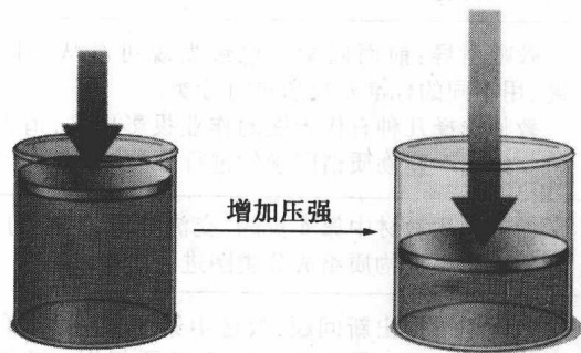
图 1-1 气态物质的压缩示意图
