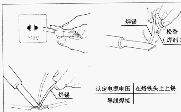
在焊锡熔化适量和焊点吃锡充分的情况下，要迅速移开焊丝并拿开烙铁头。对于小型电子元件加温时间要短，一般焊接时间为2~3秒。
