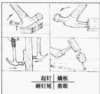
(1) 用羊角锤起钉时，必须将羊角锤一端的分叉扣紧钉帽，再使劲，而且切勿用猛力，以免闪了腰或使锤把脱手飞出，也可避免羊角形起钉口崩裂。
