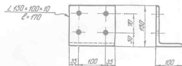
置于屋架处的连接檩子的短角钢
