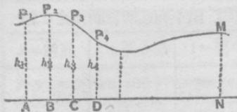
欲求曲線  $P_1P_2\dots M$  所圍之面積[圖所示者，可視作曲線之一部分]，可適當採取直線  $AN$ ，而求  $P_1ANM$  之面積。將如是之許多面積相加，則得全曲線之面積。將  $AN$  分成若干等部，由點  $A, B, C, D, \dots$  引  $AN$  之垂線  $AP_1, BP_2, CP_3, \dots$ ，令交曲線於點  $P_1, P_2, P_3, \dots$ 。又命  $AB = BC = CD = \dots = x$ ，命  $AP_1 = h_1, BP_2 = h_2, CP_3 = h_3, \dots$ ，則面積  $P_1ANM = P_1ABP_2 + P_2BCP_3 + P_3CDP_4 + \dots = \frac{1}{2}x(h_1+h_2) + \frac{1}{2}x(h_2+h_3) + \frac{1}{2}x(h_3+h_4) + \dots = x\{\frac{1}{2}(h_1+h_n) + h_2 + h_3 + \dots + h_{n-1}\}$ 。由是得次之法則：
