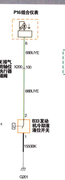
发动机控制系统示意图 (发动机冷却液液位)
