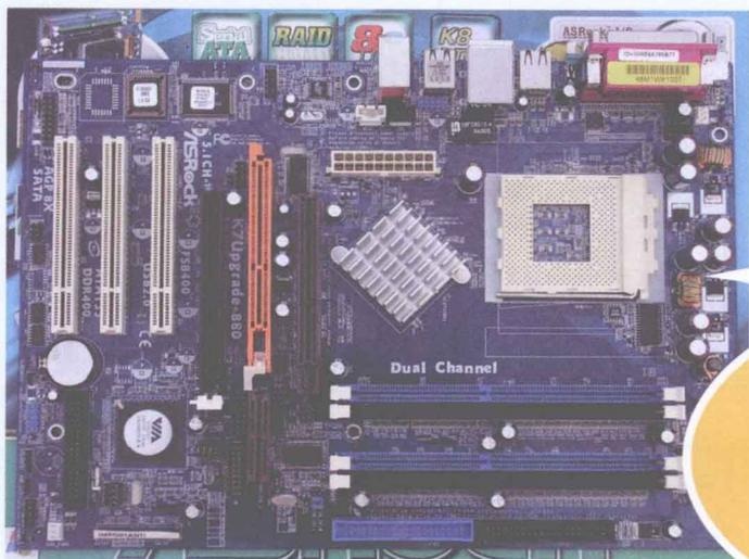
主板上可连接CPU、内存条、硬盘、显卡、声卡、数据线、电源等硬件设备。
