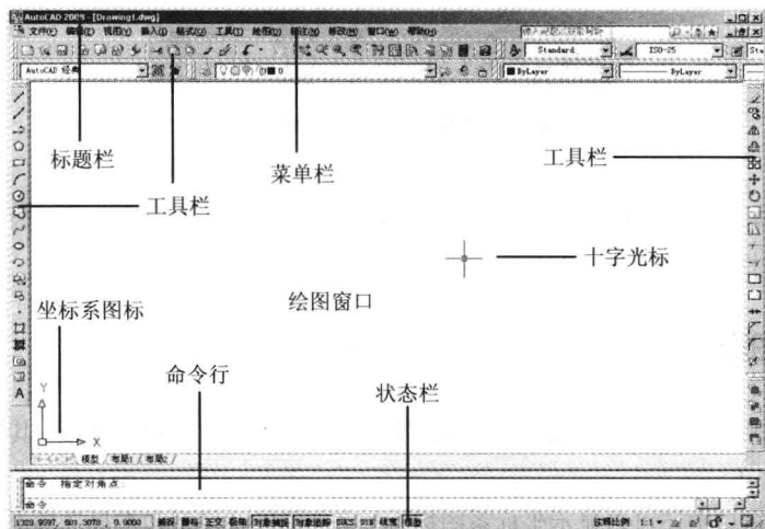
图 1.2.1 中文 AutoCAD 2008 的工作界面
