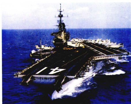
斜角甲板的應用使得航母在艦載機彈射起飛的同時，也可接收降落的飛機。
