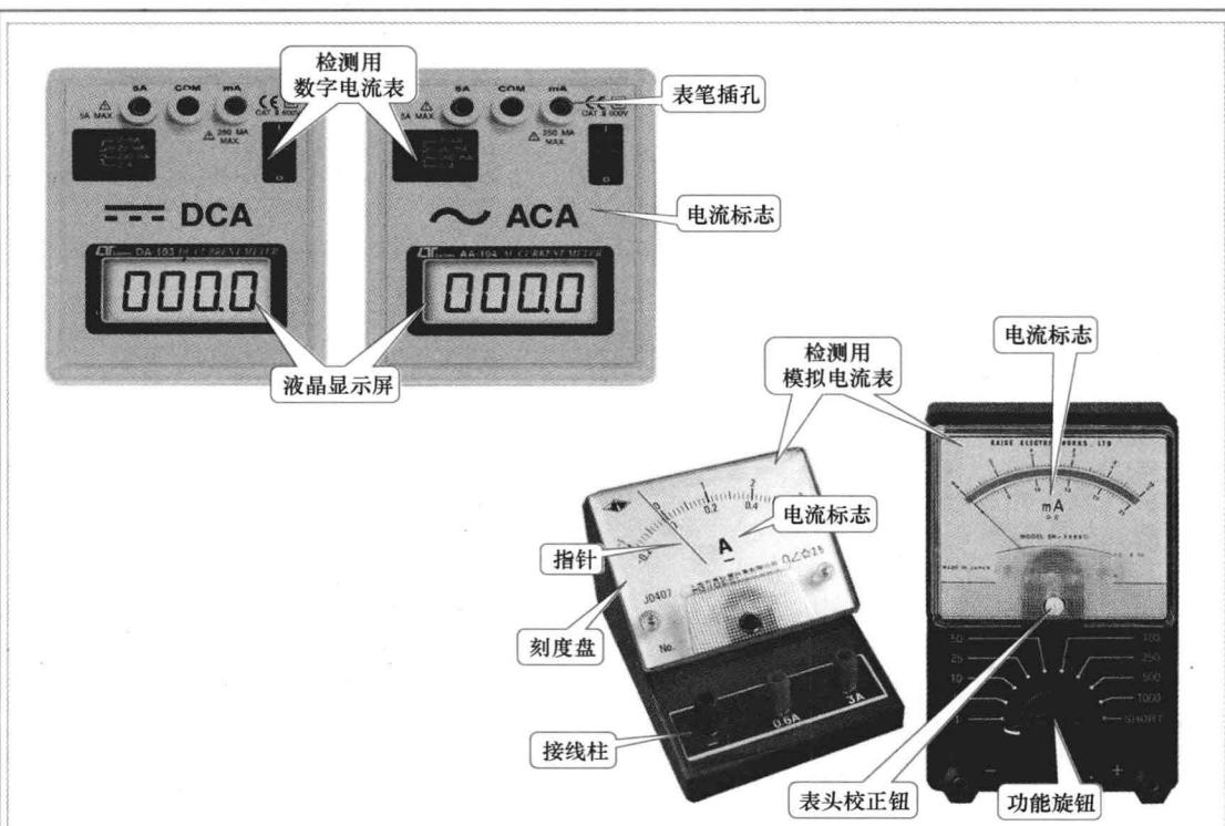
检测用电流表有可调量程和固定量程两种，其中可调量程检测用电流表的检测范围比较大，并且可以根据需要通过旋钮选择不同的量程范围，因此在电子检测中得到广泛应用。固定量程检测用电流表的测量范围是固定的，并且检测范围比较小，因此一般适合于实验室中使用。
