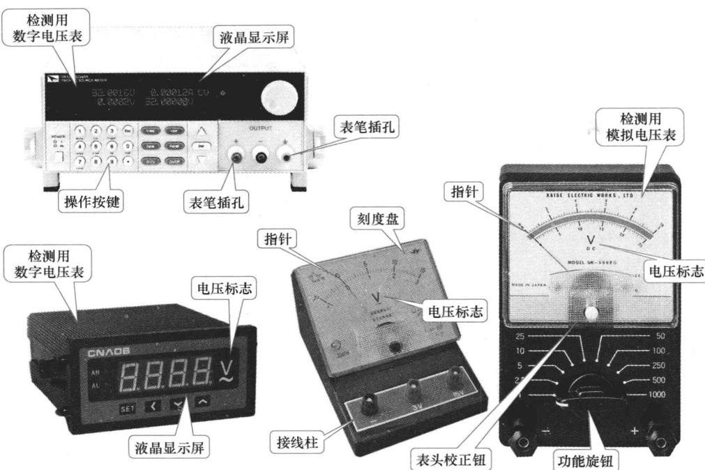
检测用电压表有可调量程和固定量程两种，其中可调量程检测用电压表的检测范围比较大，可以根据需要通过旋钮选择不同的量程范围，因此在电子检测中得到广泛应用；而固定量程检测用电压表的测量范围是固定的，而且检测范围比较小，因此一般适合于实验室中使用。
