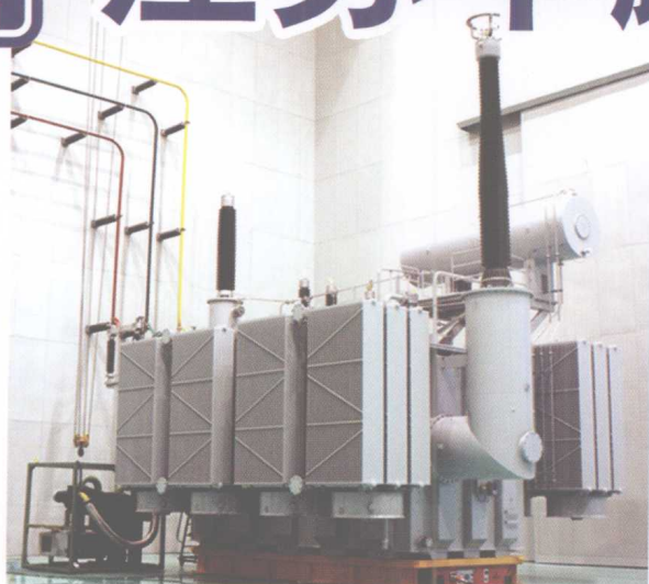
500kV级变压器
