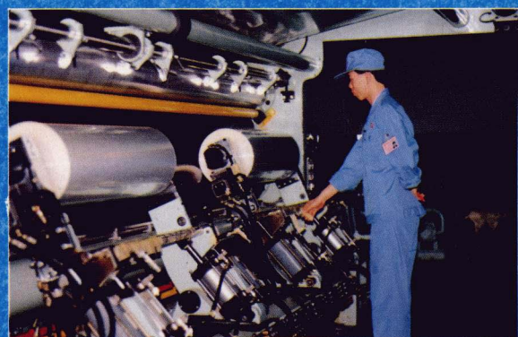
工人正在精心操作分切BOPP薄膜
