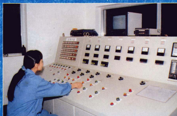
从日本引进的薄膜生产线主控台
