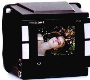
中画幅相机的成像面积往往是135相机成像面积的3至4倍。图为中画幅数码相机后背，画面大小一目了然。
