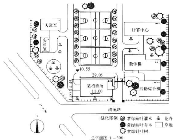
图1.5.1 某招待所总平面图
