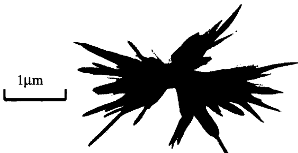
图 1 在复合薄膜上 \text{KNO}_3 颗粒的反应生成物的电子显微镜照片
