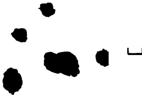
图 4 复合薄膜上 NaCl 颗粒的反应生成物的电子显微镜照片
