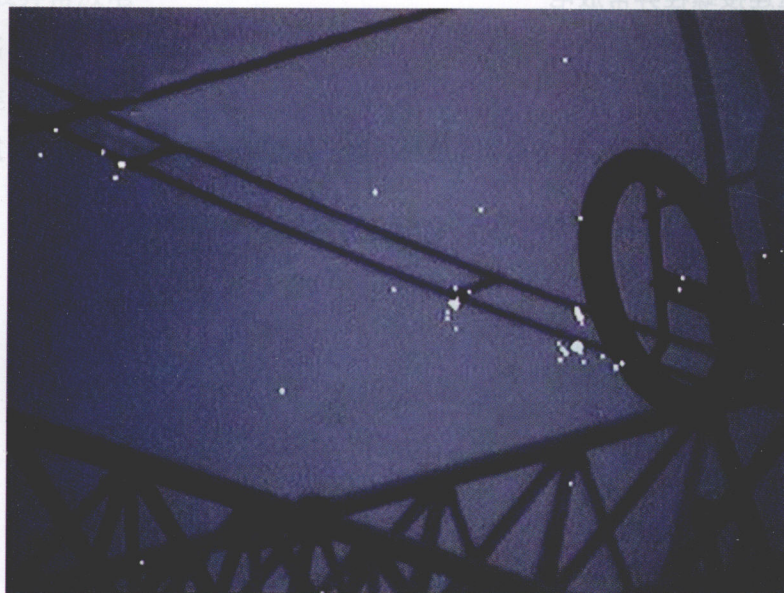
图 1-8 母线间隔棒连接松动紫外放电图谱 (二)
