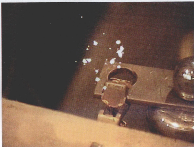
图 1-10 低压连接螺栓异常紫外放电图谱（一）
