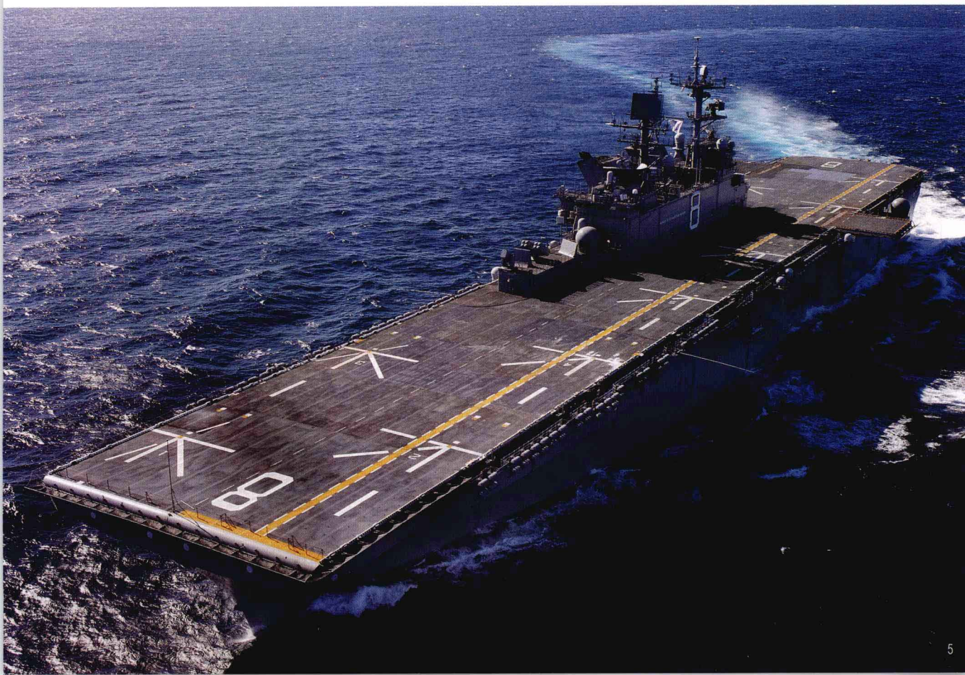
↑ 濒海战斗舰“独立”号 Independence LCS-2 (美国) 该舰是继2008年服役的“自由”号 (Freedom LCS-1) 之后的第2艘濒海战斗舰，2010年1月服役。相对于“自由号”的单体结构舰体，“独立”号采用了三体船型设计。从照片可以看出，舰体的中央和左右部分在水线以上连成一个整体，构成上层建筑。满载排水量2,790吨。 (U.S. NAVY)
