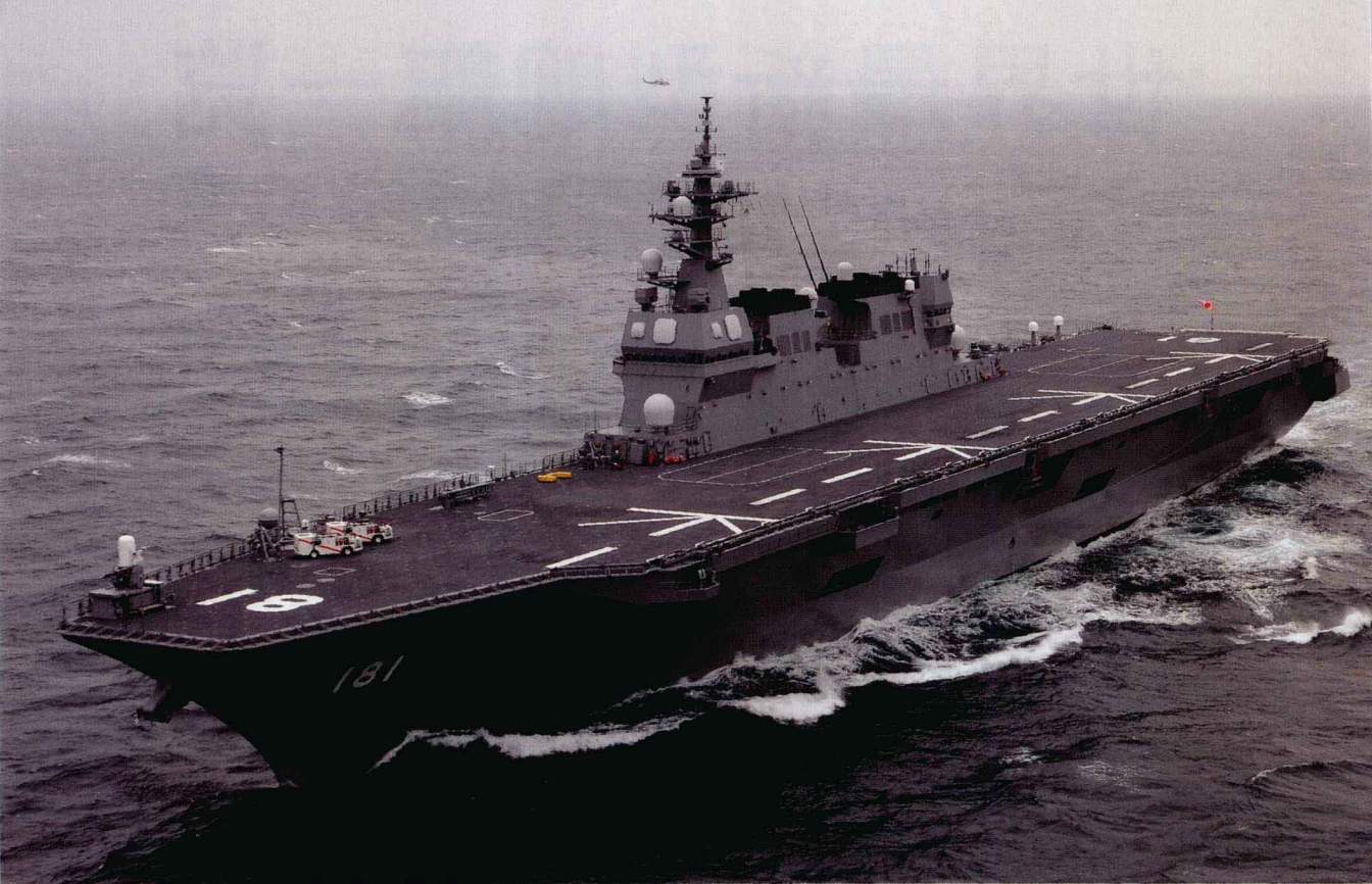
↑直升机驱逐舰“日向”号 Hyuga（日本）是日本海上自卫队第一艘全通甲板型驱逐舰，2009年3月服役。该舰的飞行甲板上设置了4个直升机起降点，舰内有直升机场，空间能够容纳10架SH-60型直升机。岛形建筑上部装有四边形的相控阵雷达，是最早在该舰进行实用化装备的FCS-3型多功能雷达。该舰满载排水量19,000吨。
