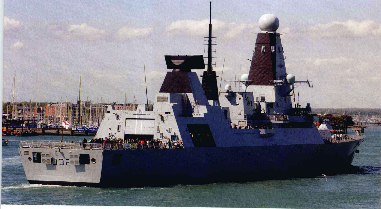
↑导弹驱逐舰“勇敢”号 Daring (英国) 该舰是“45型”驱逐舰的1号舰，2009年7月服役，同级计划建造6艘。该舰与下述“舍瓦利亚·保罗”号相同，也装备了法国制“紫苑”30/15型防空导弹，但其射击指挥采用了英国开发的“桑普森”型多功能雷达。满载排水量7,450吨 (福岛良治)
