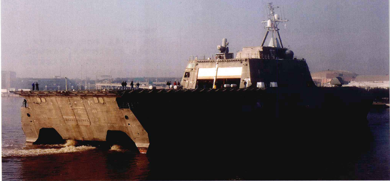
↑ 濒海战斗舰“独立”号 Independence LCS-2 (美国) 该舰是继2008年服役的“自由”号 (Freedom LCS-1) 之后的第2艘濒海战斗舰，2010年1月服役。相对于“自由号”的单体结构舰体，“独立”号采用了三体船型设计。从照片可以看出，舰体的中央和左右部分在水线以上连成一个整体，构成上层建筑。满载排水量2,790吨。 (U.S. NAVY)
