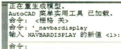
命令窗口的大小可以任意调节，将鼠标移动到命令窗口的边框线上，按住鼠标左键拖动直至窗口大小合适为止。此外，命令窗口的位置可以任意移动，只要拖动其左侧的边框就可以将它移动到任意的位置上。
