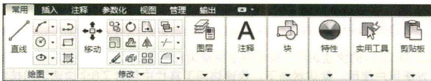
默认状态下，在“二维草图与注释”空间中，“功能区”选项卡有7个选项卡：常用、插入、注释、参数化、视图、管理和输出。每个选项卡中又包含多个面板，每个面板又包含许多由图标表示的命令按钮。
