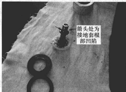
图 1-13 接地套根部电弧烧蚀呈凹陷状
