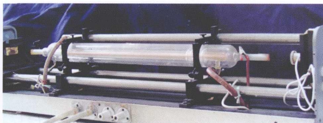
研制成功的我国第一台同位素 ^{13}\text{CO}_2 激光器
