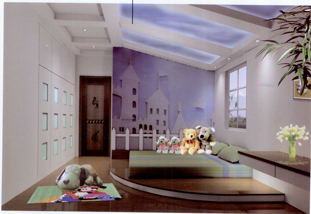
石膏板吊顶，乳胶漆饰面
