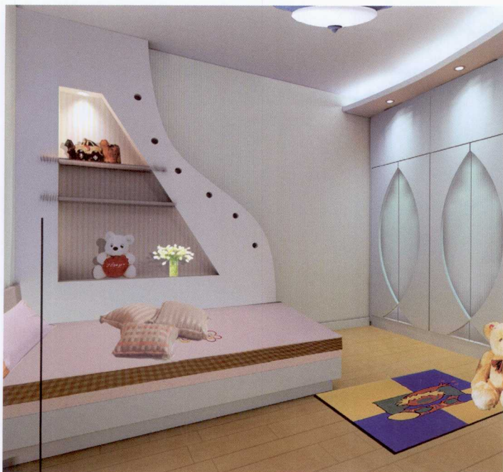
石膏板造型，乳胶漆饰面
