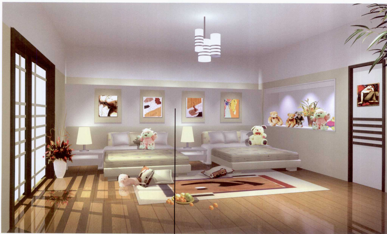
石膏板造型，乳胶漆饰面
