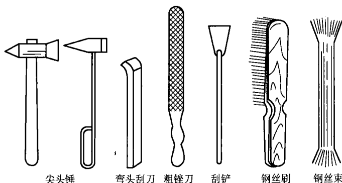
图 2-1 手工除旧漆、除锈工具
