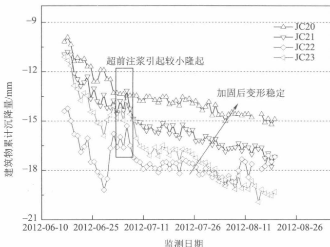
图7 注浆加固后建筑物的累计沉降曲线
