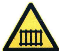
图 2-34 有人看守 铁路道口
