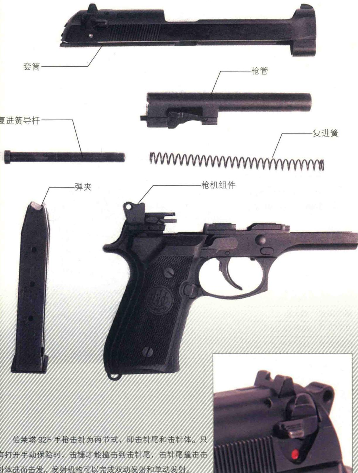
伯莱塔 92F 手枪击针为两节式，即击针尾和击针体。只有打开手动保险时，击锤才能撞击到击针尾，击针尾撞击击针体进而击发。发射机构可以完成双动发射和单动发射。
