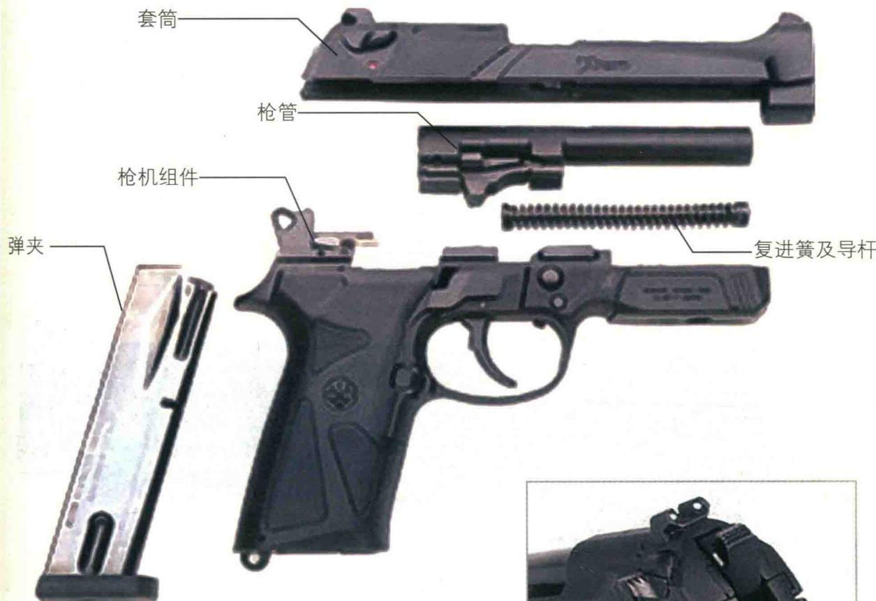
击锤制成空心形，重量更轻、速度更快。伯莱塔90TWO手枪的击发机构有F型和G型两种，均为单、双动击发机构。其区别在于F型有手动保险兼待击解脱杆，而G型只有待击解脱杆。两者均有自动击针保险。
