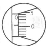
图 1-5 螺旋测微计的零点读数
