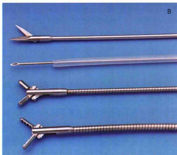
图1-9 一个带有操作护套和纤维器械直径为2.7mm的硬质内镜。A，为通过操作护套的通道插入活检钳；B，为通过操作护套进行的纤维器械：剪刀、注射器或抽吸、针头、活检钳、鳄鱼钳。（引自Tams TR: Small Animal endoscopy, ed 2, St Louis, 1999. Mosby）
