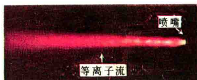
图6 低气压下的等离子流200 A， 容器内压力6.5 mmHg
