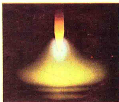
图12 低压气体中的TIG 电弧 (D.C.S.P.) P = 32\text{ mmHg} , 水冷铜板, 电极 \phi 4\text{ mm} 弧长15 mm, 200 A, 采用滤色镜
