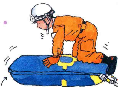
气压千斤顶（电车事故等发生时使用的工具）
