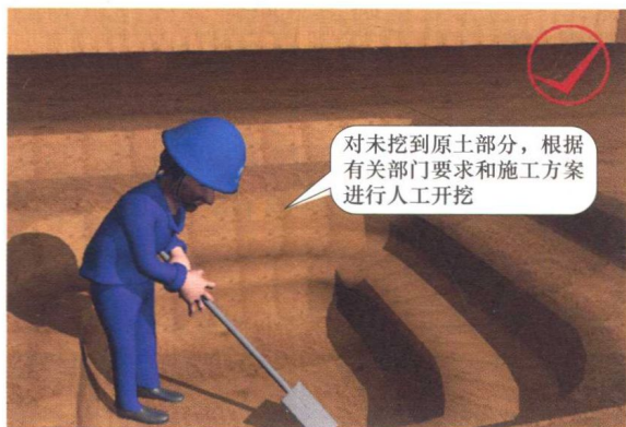
图 2-10 局部地基加深处理示意图
