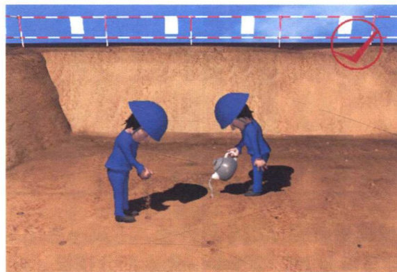
图 2-9 钎孔灌水试验
