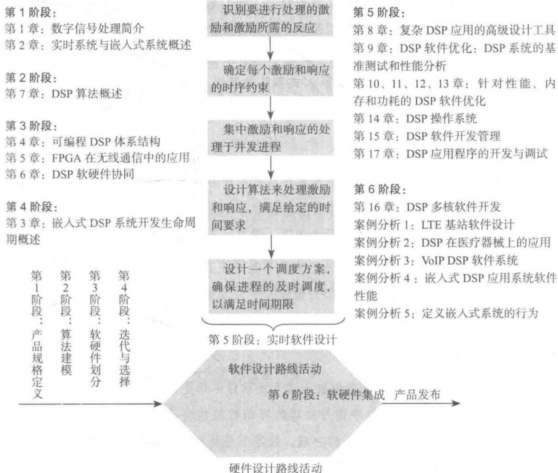
图 1 DSP 软件开发遵循嵌入式软硬件协同设计模型
