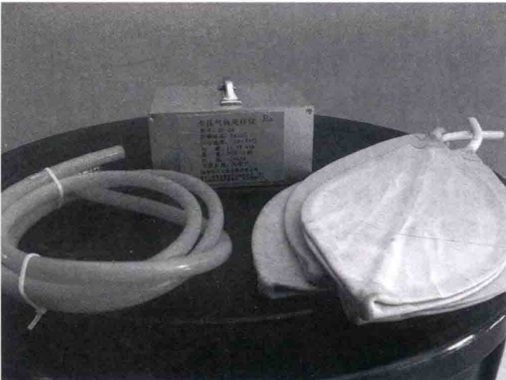
图 2-2 抽气泵、气囊和连接管
