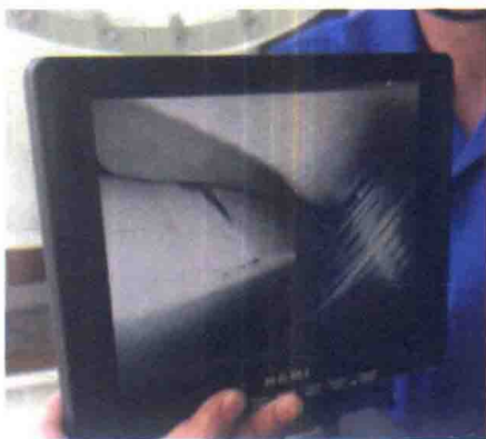
图 1-12 缺陷定位部位内窥镜检查结果
