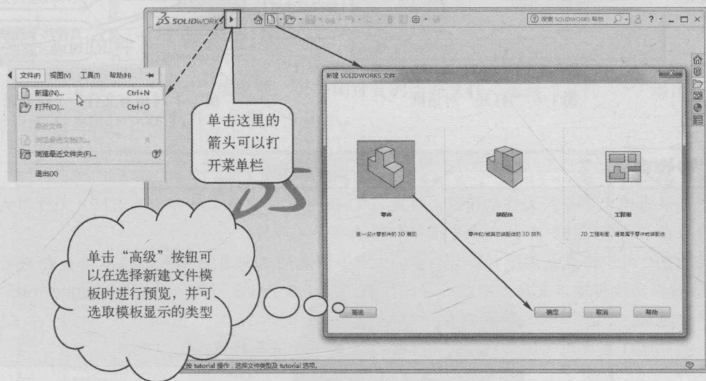
图 1-5 SolidWorks 2018 的启动界面和新建零件文件的操作
