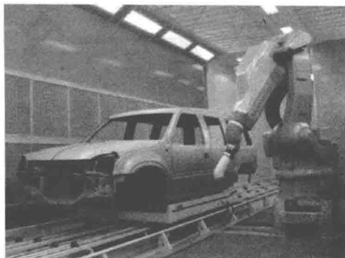
图 1-6 汽车制造涂装流水线
