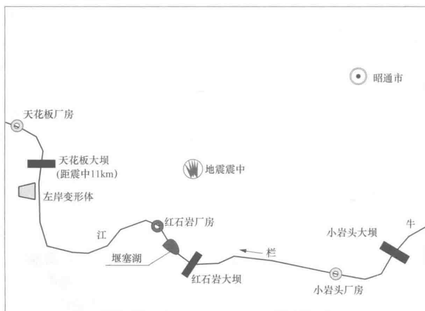
图2 堰塞湖与上下游电站平面位置示意图
