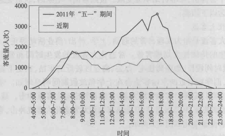
图 1-2 某地铁车站“五一”期间和平日的全日闸机进站量对比
