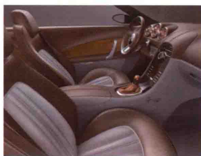
图 3-68 亚光纹的仪表板和真皮表面的座椅
