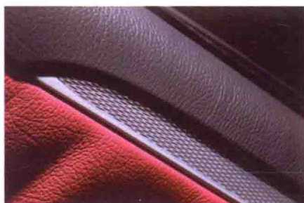
图 3-66 橘皮纹的塑料表皮配以金属亚光装饰条的门内护板
