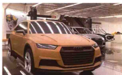
图 4-26 1 : 1 全尺寸油泥模型
