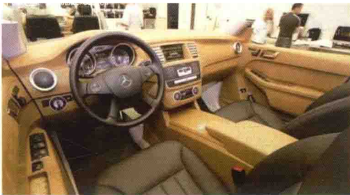
图 4-33 全尺寸内饰油泥模型
