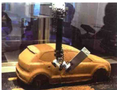
图 4-24 五轴数控铣床加工模型
