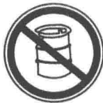
(c) 禁止堆放易 燃物
