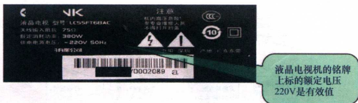
图 1-5 电器上标注的电压一般是有效值
