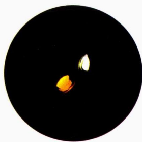
图 13 非均质体在 45^\circ 时正交偏光镜下现象
