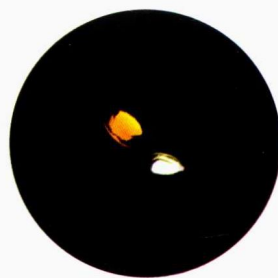
图 15 非均质体在 135^\circ 时正交偏光镜下现象
