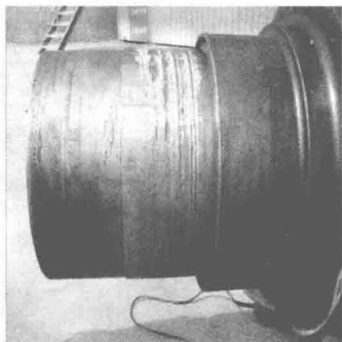
图1-3 机械加工后表面受到损伤的轴
