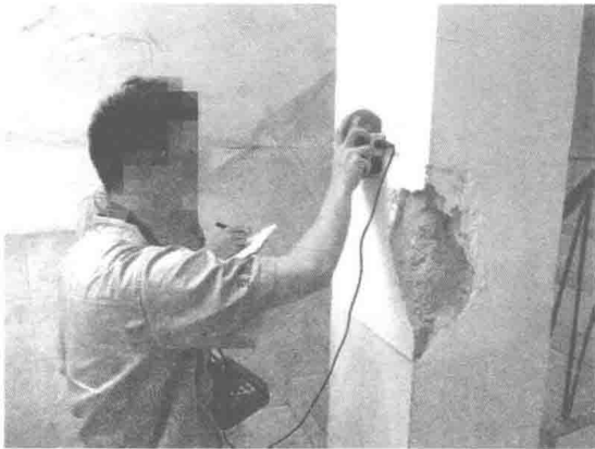
图 1.3 超声波法测混凝土强度
