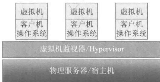
图1.1 一个基本的虚拟机监视器
