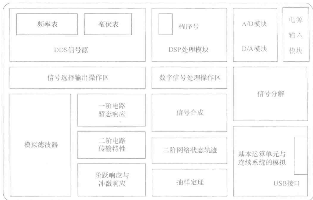
图 1.1.1 RZ8663 实验系统分布示意图
