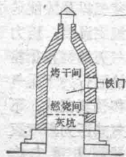
图5 焚化炉结构示意图
