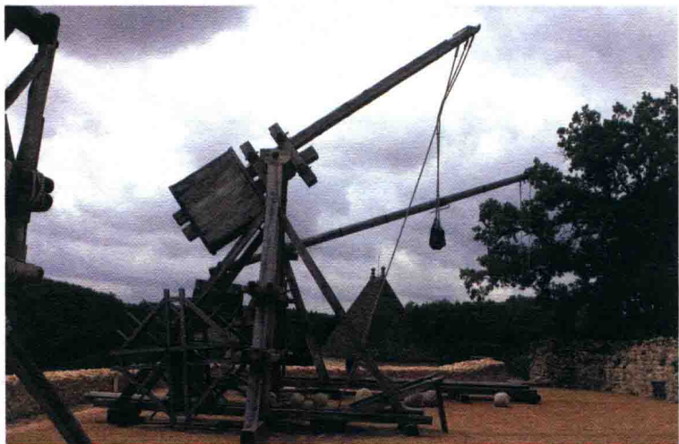
抛石机出现于中世纪初期，使用至15世纪，主要利用重物的重力发射，用于围攻和防守要塞。
