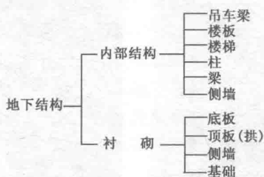
图 1-1 地下结构的组成
