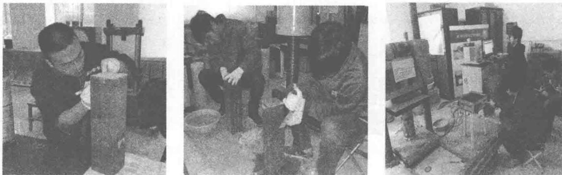
图 1.7 钢管约束混凝土柱分组试验
